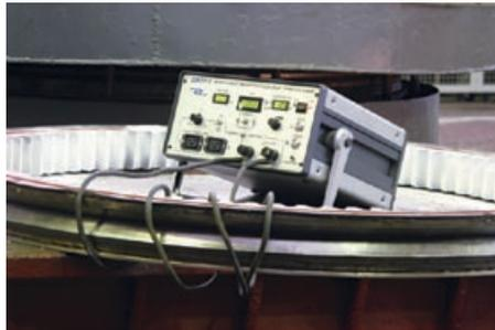
Рис. 7. Продольное намагничивание участка венца экскаватора гибким кабелем
