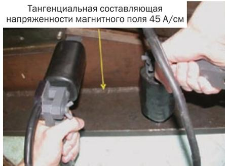
Рис. 9, 10. Использование электромагнита «ИНТРОТЕСТ ЭМ-02» для намагничивания изделий сложной формы
