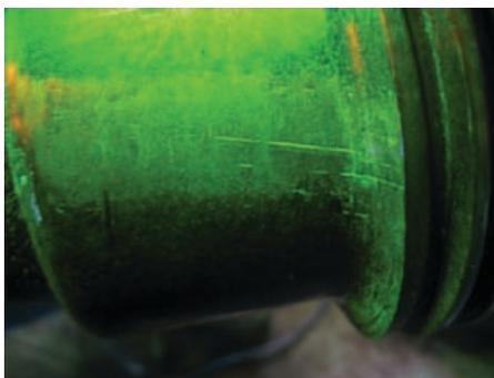
Рис. 5. Дефекты на насаженной части трубы
