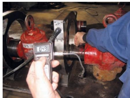
Рис. 3. Контроль тангенциальной составляющей напряженности магнитного поля при продольном намагничивании задвижек
