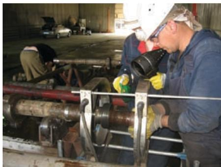
Рис. 4. Контроль трубной резьбы с использованием удлинителя
