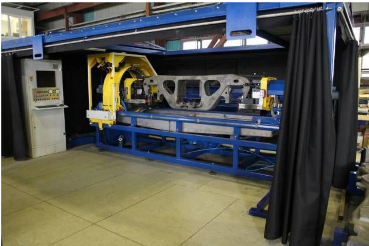
**Рис. 3. Установка УМК-ЖЛ1. Общий вид с установленной контролируемой деталью «Рама боковая».**
