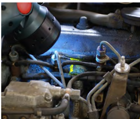
Регистрация утечки в двигателе с помощью флуоресцентного концентрата H 800
